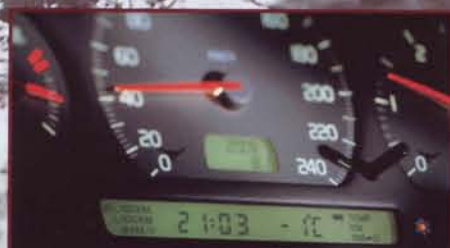
2 トリップコンピュータ ディスプレイの左側に常時、時刻を表示し、コントロールスイッチの切り替えでディスプレイの右側に外気温度、平均速度、現在燃費、平均燃費、走行距離（トリップメーター）、走行可能距離の情報を表示します。尚、燃費はL/100km表示です（100kmを走行するのに必要な燃料の量）。
