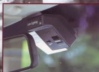
3 オートライティング (S/V) 車外の明暗にセンサーが反応し、スモールあるいはヘッドライトの点灯と消灯をコントロールします。作動中はグリーンのランプが点灯。
