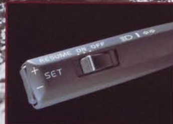
1 クルーズコントロール セットした速度を維持する装置です。時速35km以下では作動しません。
