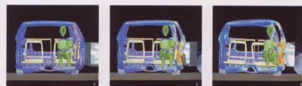
▲SIPSの働き（衝撃吸収度）をコンピュータ・グラフィックスで再現したものです。
