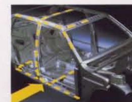
1991 SIPS(Side Impact Protection System):側面衝撃吸収システム
